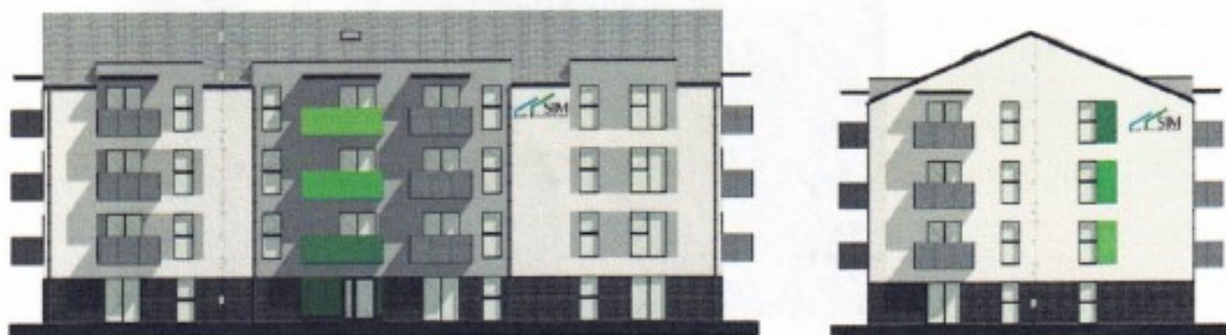
Rys. 6. Elewacje budynku z dachem skośnym
