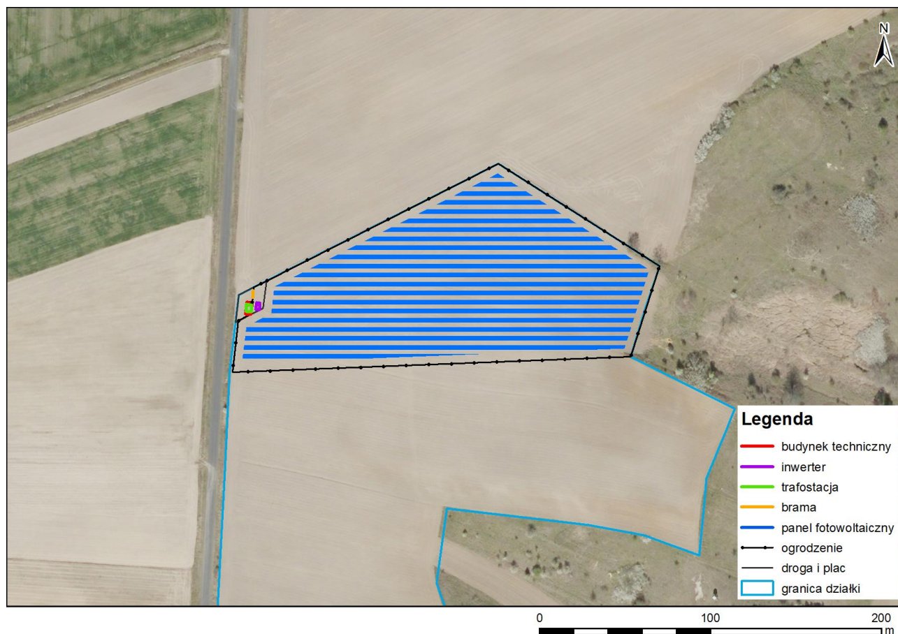
Rysunek 4 Wstępne rozmieszczenie poszczególnych elementów farmy fotowoltaicznej
