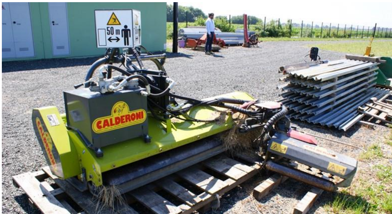
Rysunek 27 Dostawka do ciągnika rolniczego służąca do wykaszania terenu farmy
