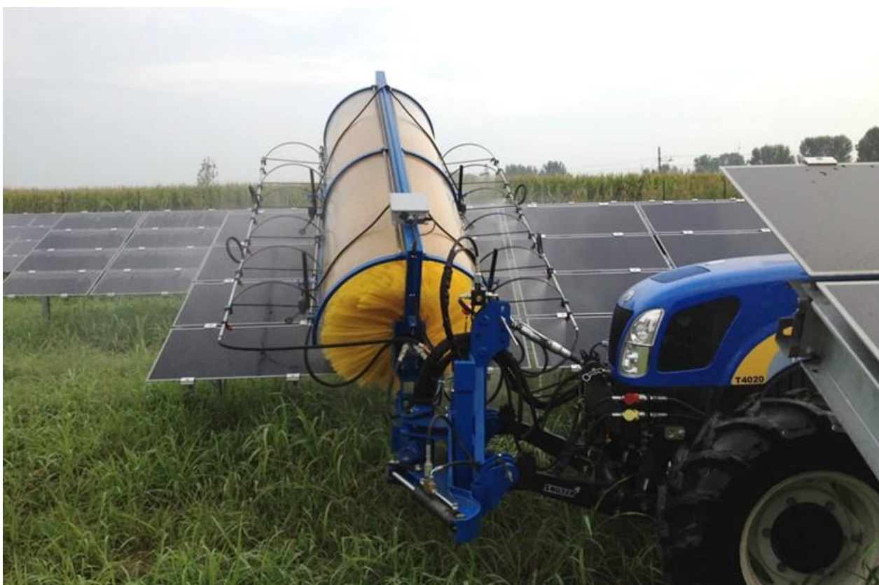
Rysunek 26 Mycie paneli fotowoltaicznych za pomocą specjalnej dostawki do ciągnika rolniczego
