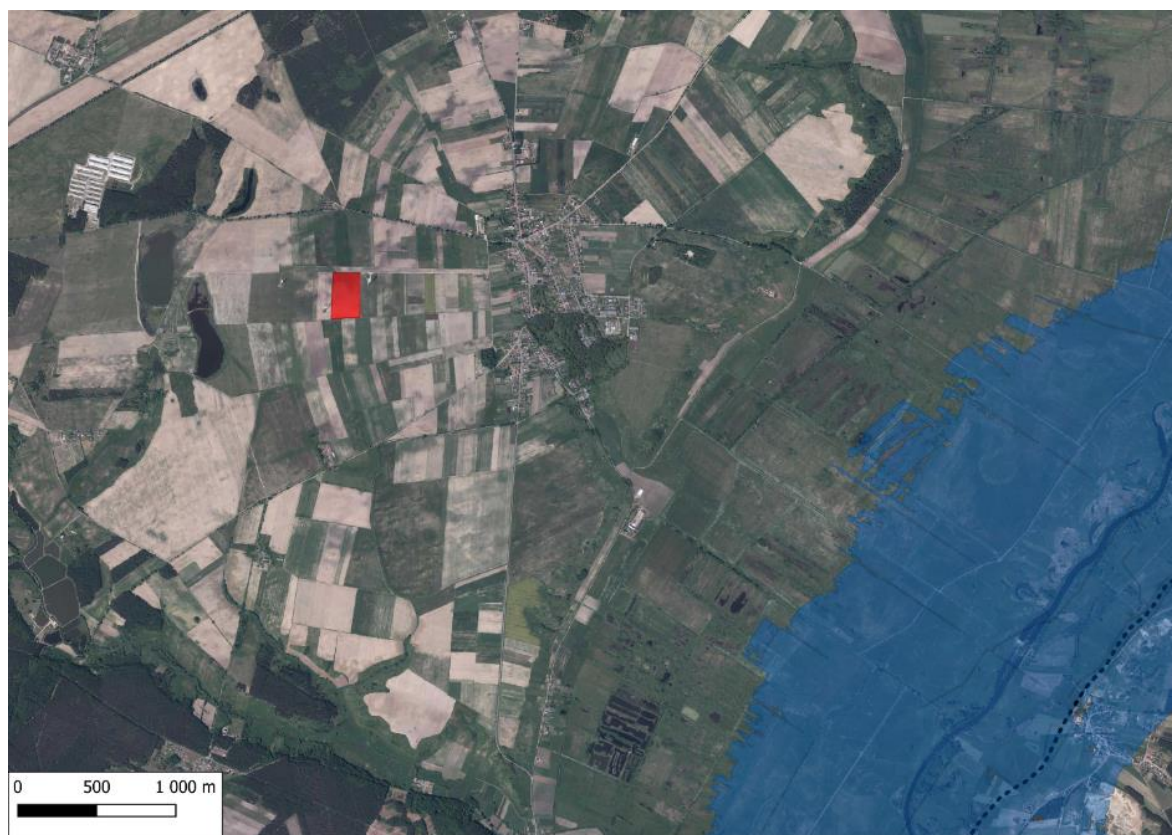
Rysunek 12 Lokalizacja działek inwestycyjnych 257, 258 na mapie zagrożenia powodzią (prawdopodobieństwo zagrożenia powodziowego 1% – kolor ciemnoniebieski).
