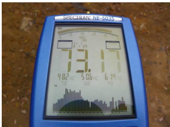
FOTOGRAFIA 10. Pomiar składowej elektrycznej (na lewo) i składowej magnetycznej (na prawo) w punkcie pomiarowym zlokalizowanym w odległości ok 5m od transformatora średniego napięcia [fot. Krzysztof Kręciproch]
