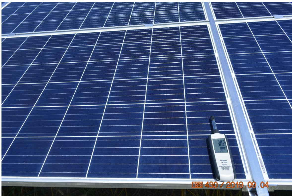
FOTOGRAFIA 12. Pomiar temperatury i wilgotności powietrza bezpośrednio nad panelami fotowoltaicznymi na farmie fotowoltaicznej w Krzyżowicach w dniu 4 września 2019 r.
