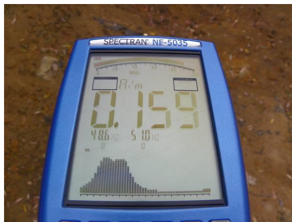
FOTOGRAFIA 10. Pomiar składowej elektrycznej (na lewo) i składowej magnetycznej (na prawo) w punkcie pomiarowym zlokalizowanym w odległości ok 5m od transformatora średniego napięcia [fot. Krzysztof Kręciproch]
