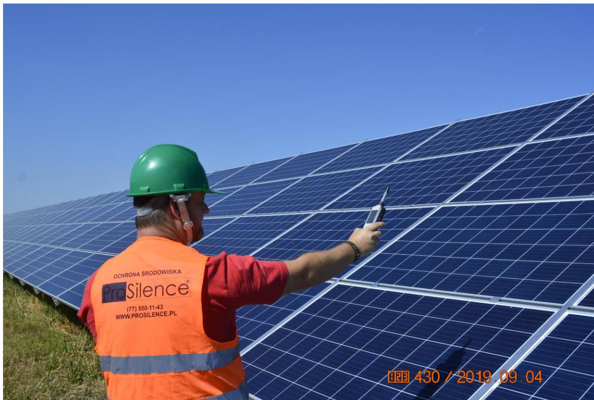
FOTOGRAFIA 13. Pomiar temperatury i wilgotności powietrza ponad panelami fotowoltaicznymi na farmie fotowoltaicznej w Krzyżowicach w dniu 4 września 2019 r.
