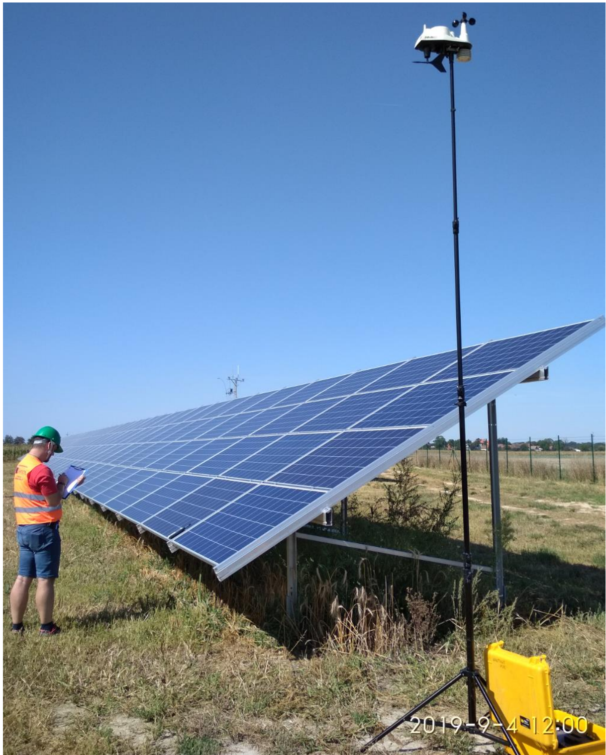
FOTOGRAFIA 11. Monitoring warunków meteorologicznych podczas badań prowadzonych na farmie fotowoltaicznej w Krzyżowicach w dniu 4 września 2020 r.
